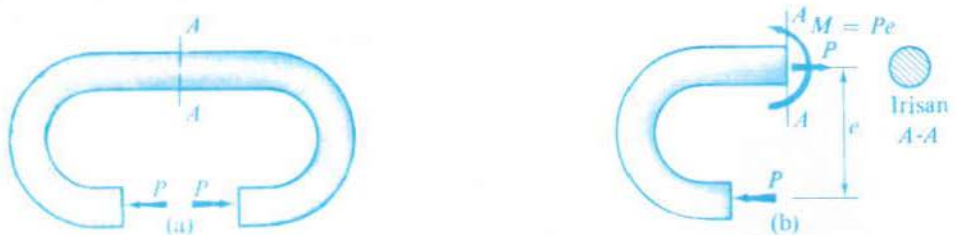
Gambar 1-5 Bagian mesin dengan distribusi tegangan yang tidak merata pada Irisan A - A .
